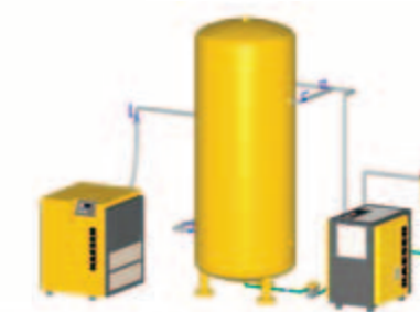
Installationsexempel 1: Den vanligaste modellen: kompressor, tank och kyltork
